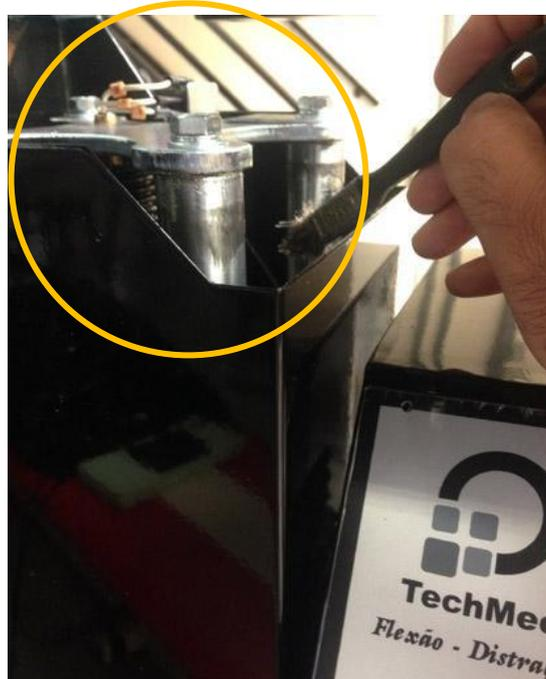
B. Posteriormente, através do pedal duplo de elevação, suba a coluna até sua altura máxima e realize a lubrificação dos 4 eixos em sua parte inferior.
