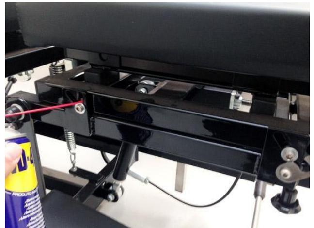
B. A lubrificação do **Drop Torácico** necessita levantar o estofamento do mesmo e posicionar a alavanca do Drop para baixo, para que o pino de acionamento suba e possa ser lubrificado.
